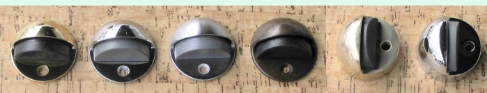
606 LV 606 OC 606 CS 606 OB 607 LV 607 OC 606: průměr 48 mm, výška základny 4 mm, celková výška 24 mm 607: průměr 48 mm, výška základny 14 mm, celková výška 34 mm
