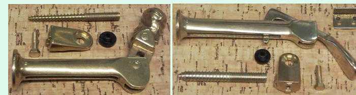
595 OL 596 OL ovládání překlopením hlavy okenice zaklapne za vahadlo gumový doraz a nastavitelná tloušťka okenice do 55 mm
