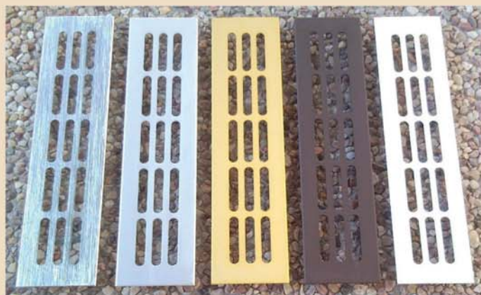
Větrací mřížky z hliníkového profilu, kartá- čované, eloxované nebo stříkané barvou, rozměry od 60 x 250 do 150 x 2000 mm
