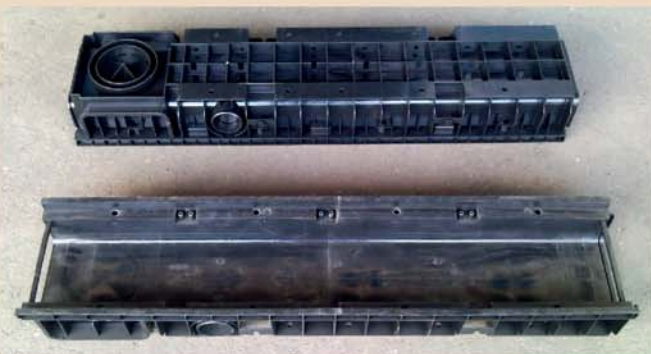
2007P - žlábek 200x75x1000 mm Boční vývod 63 mm, spodní vývod 110 a 140 mm. Obsahuje 2 příruby pro kolmé připojení dalších žlábků.
