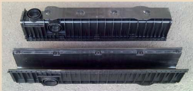
1315 - žlábek 130x150x1000 mm Boční vývod 72 a 100 mm, spodní vývod 72 a 100 mm.
