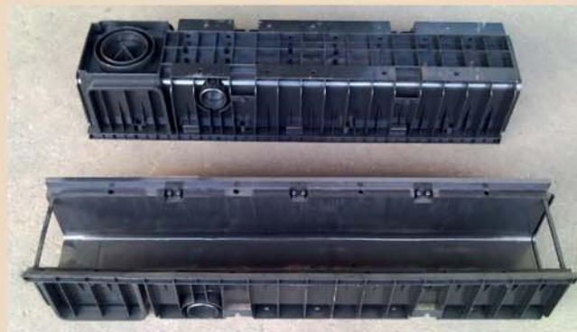
2015P - žlábek 200x150x1000 mm Boční vývod 63 mm, spodní vývod 110 a 140 mm. Obsahuje 2 příruby pro kolmé připojení dalších žlábků.
