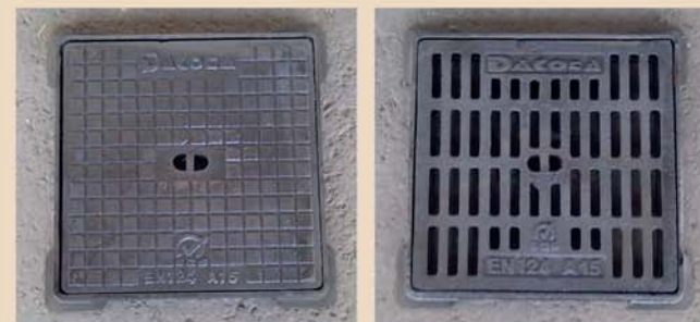
Rámečky od 200 mm do 550 mm litinové, zakryté víkem nebo roštem, nosnost 1500 kg
