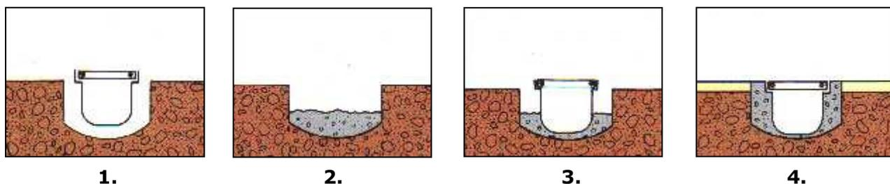
**1.** Připravte si výkop a průběžně kontrolujte hloubku a šířku výkopu. Délka výkopu odpovídá celkové délce všech žlábků. Šířka výkopu je přibližně 1,5 až 2 násobek šířky žlábků. Hloubka výkopu by měla být přibližně 1,5 násobek hloubky žlábků.
